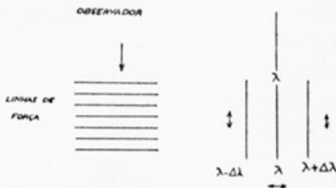
Fig. 1 — O simples e clássico efeito Zeeman. As setas indicam o sentido da polarização
