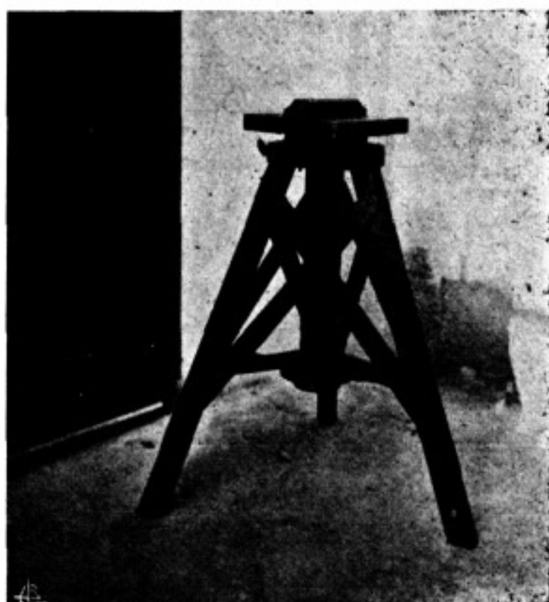
Réguas de Monteiro da Rocha (Tripe e mesa de altura variável, notando-se um cilindro de latão onde corre a régua)
