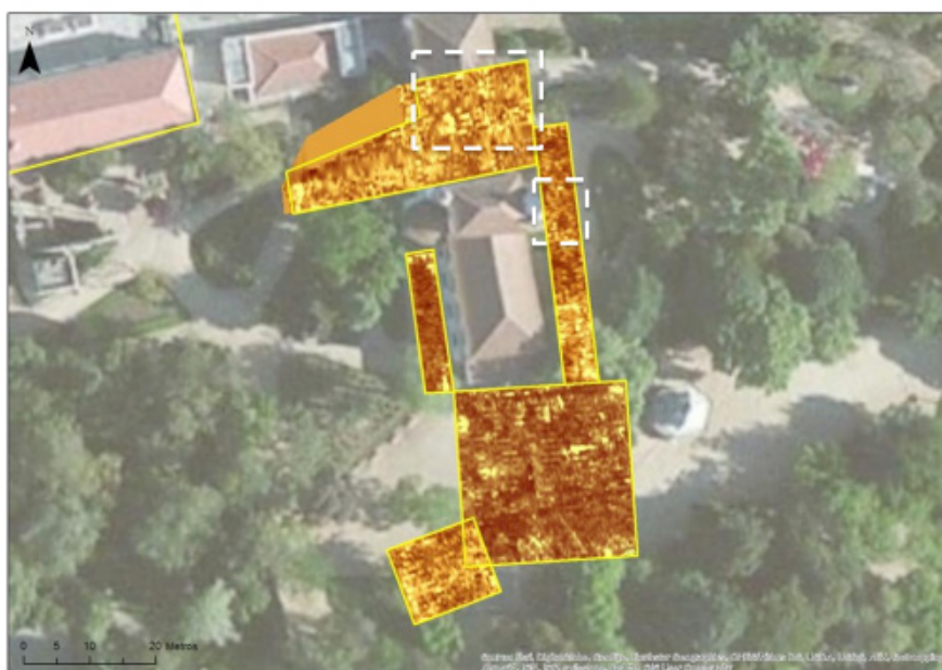
Figura 6- Imagem conjunta do levantamento em georradar, com integração dos níveis a diferentes profundidades.
