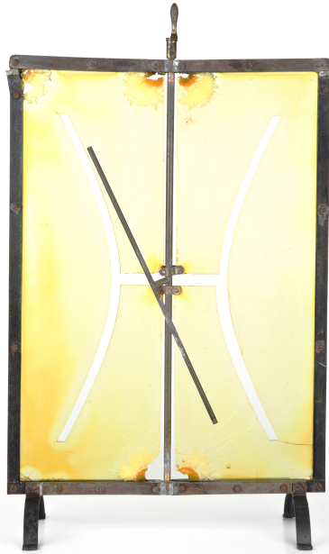
Figura 7.5: Modelo XXXIX da casa de Martin Schilling, representando a geração de um hiperbolóide de uma folha através da rotação de uma reta em torno de um eixo. A hipérbole resultante da secção do hiperbolóide por um dos planos que contém o eixo é exibida no modelo (Altura do modelo: 50 cm). Modelo adquirido, no início de 1912, para a cadeira de Geometria Descritiva, sendo o primeiro de um conjunto de cerca de meia centena de modelos geométricos que, até ao final do ano letivo de 1913-14, se adquirem à mesma casa de instrumentos científicos. Este modelo apresenta atualmente um estado de conservação muito precário devido à deterioração contínua da placa central feita em celuloide.
