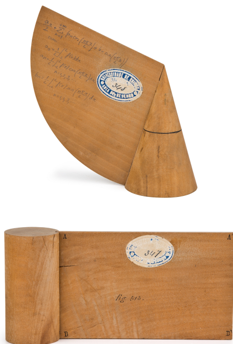
Figura 7.4: Modelos de superfícies planificáveis requisitados pelo professor de Geometria Descritiva na sessão do Conselho da Faculdade de Matemática de 19.2.1881 (Altura dos modelos: 13 e 7 cm). Numa pequena folha de papel, onde faz a requisição, Rocha Peixoto indica estarem os modelos à venda na Librairie polytechnique Baudry, localizada na rue des Saints-Pères, em Paris (UC, Correspondência , 1881).
