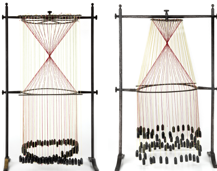
Figura 7.6: Modelos IV-2 e IV-3 da casa Schilling, adquiridos em junho de 1914, e fazendo parte da última encomenda de modelos geométricos feita a esta casa de instrumentos científicos (Altura dos modelos: 55 e 50 cm). Estando os círculos diretores colocados em posição paralela, os modelos exibem uma série de formas hiperbólicas cujas formas limites são um cilindro (modelo IV-2) ou um cone truncado (modelo IV-3), e um cone de duas folhas. Tal como os modelos de Théodore Olivier, estes modelos possuem partes móveis, sendo construídos com fios de seda que permanecem sob tensão pela ação de pesos.
