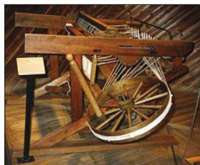
Fig. 30 - Máquina de fiar em fábrica hidráulica (Fonte: [4]).
