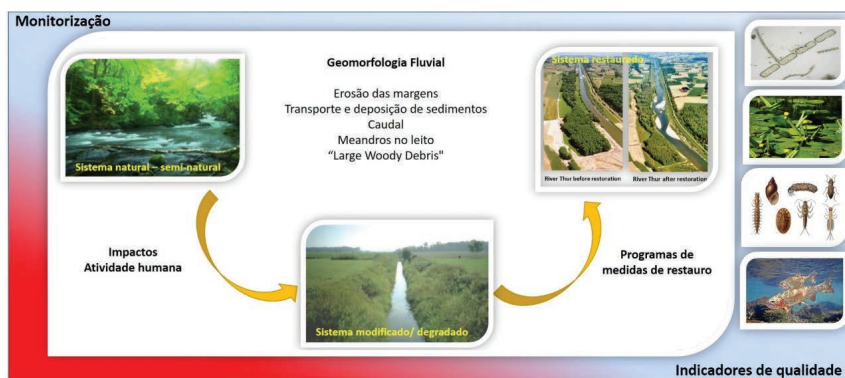
Figura 15.1. Os programas de restauro fluvial pretendem reestabelecer processos naturais hidrológicos e morfológicos encontrados em sistemas não perturbados, junto com a minimização de impactos de origem humana. Os elementos de qualidade biológica – os bioindicadores – são utilizados para monitorizar e avaliar a eficácia das medidas implementadas.
