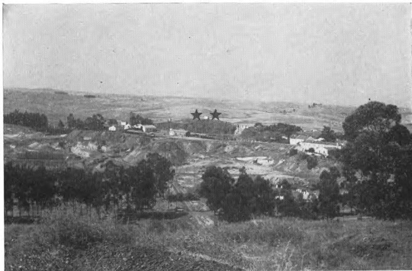
FIG. 5 — Aljustrel: le chapeau de fer du gisement des Algarès est particulièrement visible au centre du cliché. Deux étoiles indiquent l'emplacement des sondages, de part et d'autre du château d'eau, sur le versant opposé du «gossan».
