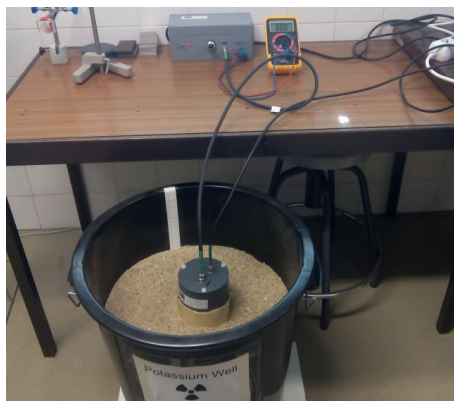
Figura 1. Fotografia do contentor com uma mistura de areia do rio e cloreto de potássio, onde foi colocado o detetor de NaI:TI.
