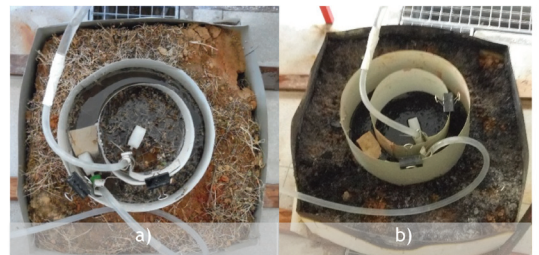
Fig. 3 - Ensaio com infiltrómetro de duplo anel: a) amostra A; b) amostra D.
