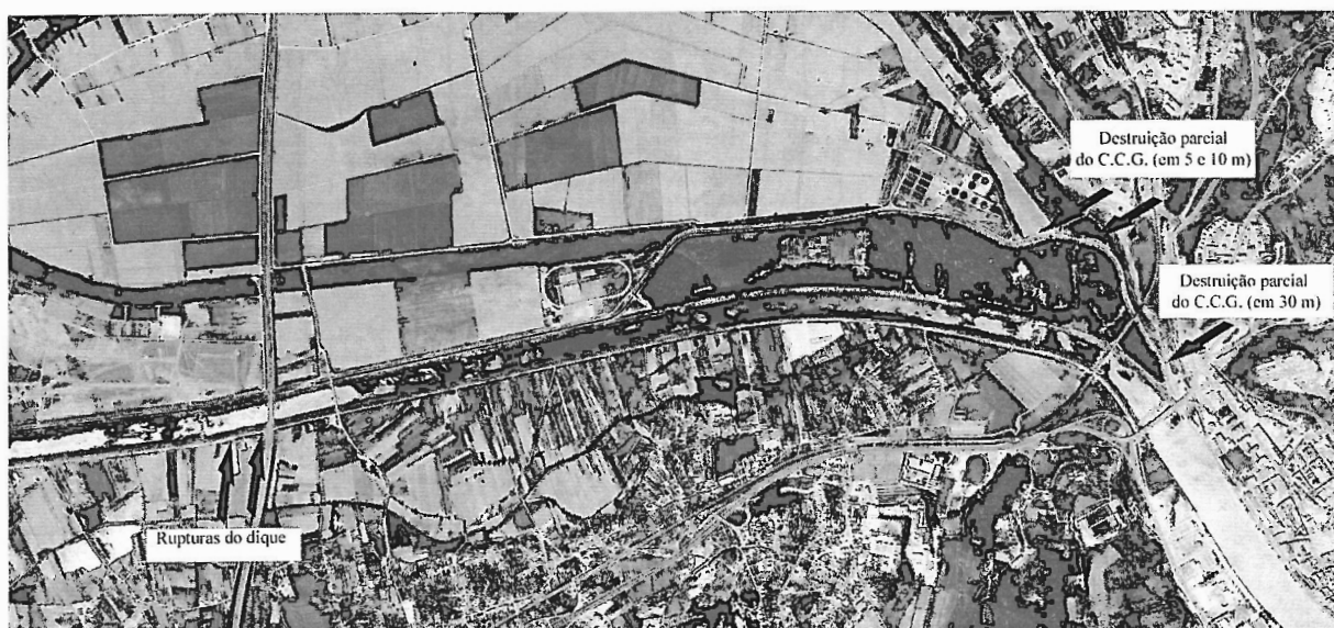
Foto 1 – Localização dos estragos nas estruturas hidráulicas entre Coimbra e a Ribeira de Frades (adap. a partir de ortofoto do CNIG de 1995). Junto ao Choupal ocorreu destruição de dois troços do Canal Conductor Geral; situam-se duas rupturas no dique em Ribeira de Frades, junto a uma quinta agrícola e à auto-estrada A1.
