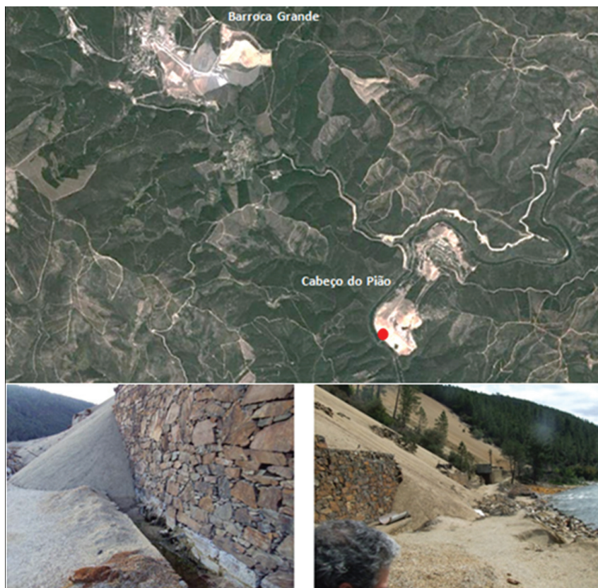
Fig. 4 - Localização do local onde ocorreram os deslizamentos (Google Earth). Deslizamento recente e que tapa a conduta de águas (vista em ângulos diferentes, à esquerda sentido montante e à direita sentido jusante).
