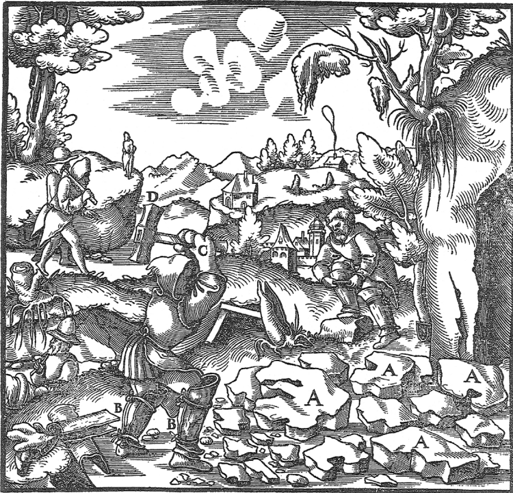
FIG. 9 – G. Agricola, De Re Metallica, 1561, libro VIII, ilustración de un modo de triturar el minera a pie de mina en la región de Goslar: A, mineral; B, protecciones de corcho para las piernas; C, guantes; D, mazo de hierro
