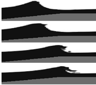
Figura 4.21 - Forma da onda em fase de rebentação sobre um recife com altura h_{rec} = 1.90 m e submersão S = 1.50 m. Onda incidente com altura H = 1.50 m e período T = 9 s (Antunes do Carmo et al. , 2011a).
