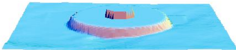
Figura 5.20 - Proteção do farol do Bugio situado na embocadura do estuário do rio Tejo. Plataforma de dissipação submersa.
