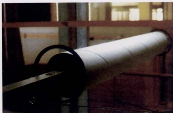
Ensaio no túnel de vento do IST de um tirante da ponte Wind tunnel test of a bridge stay at IST
