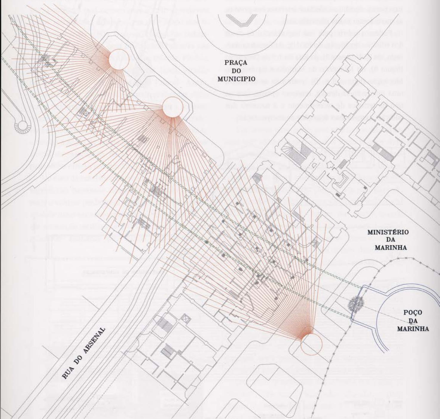
Figura 9 - Planta de localização das injeções de compensação efectuadas na Praça do Município e no Ministério da Marinha Figure 9 - Plan with the layout of compensation performed in "Município" square and Navy Ministry
