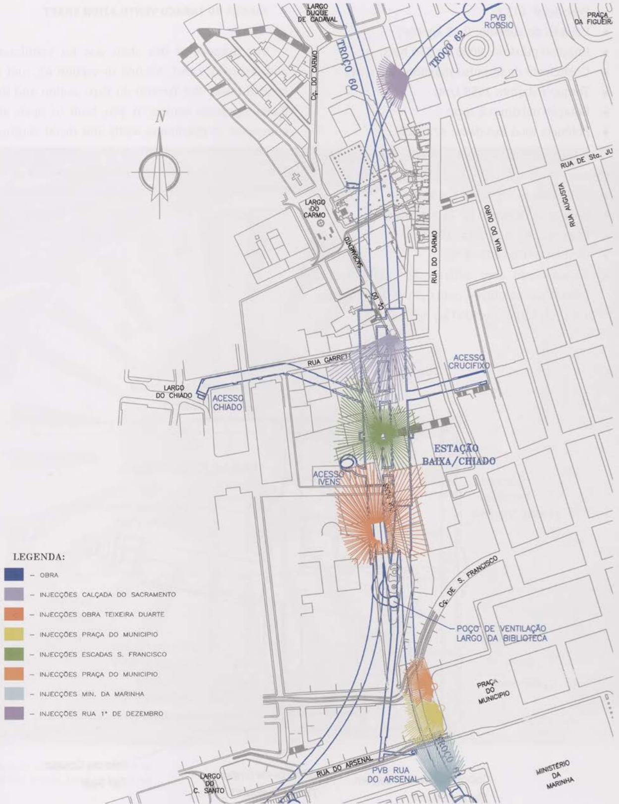
Planta da zona da Baixa com os poços de injeção de compensação Baixa zone plan with jet grouting shafts.
