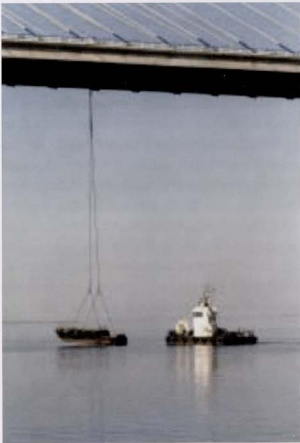
Ensaio de vibração livre: (a) Barcaça de 60 t excentricamente suspensa; (b) Início do corte da barra de betão Diwidag suspensa; (c) Liberação da barcaça. Free vibration test: (a) Excentrically suspended 60t barge; (b) Starting cut of hanging Diwidag bar; (c) Release of barge
