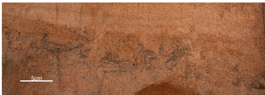
Fot. 2 - Pormenor das deformações dos leitos de minerais pesados por liquefação, na praia arenosa estuarina (ii).
