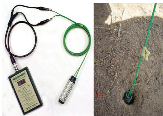
Fig. 3 - Medidor portátil Watermark (Fonte: Irrometer Company, 2008) e instalação do bloco de matriz granular.
