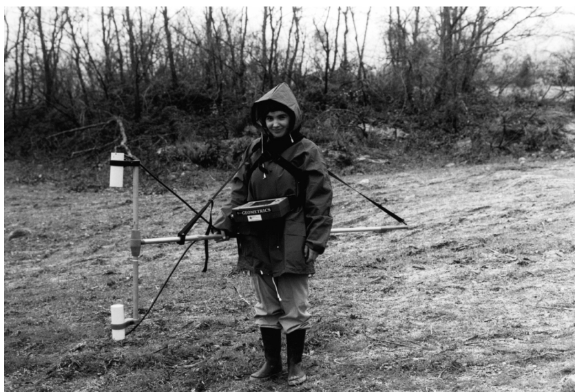
FOTO 4 – Operadora equipada com o magnetómetro a vapor de Césio G-858 da Geometrics.
