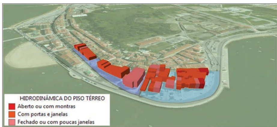
Figura 3 - Representação da altura do edificado e da hidrodinâmica do piso térreo a partir de dados recolhidos com a aplicação Collector for ArcGIS® instalada em dispositivo móvel (Projeto MOLINES)
