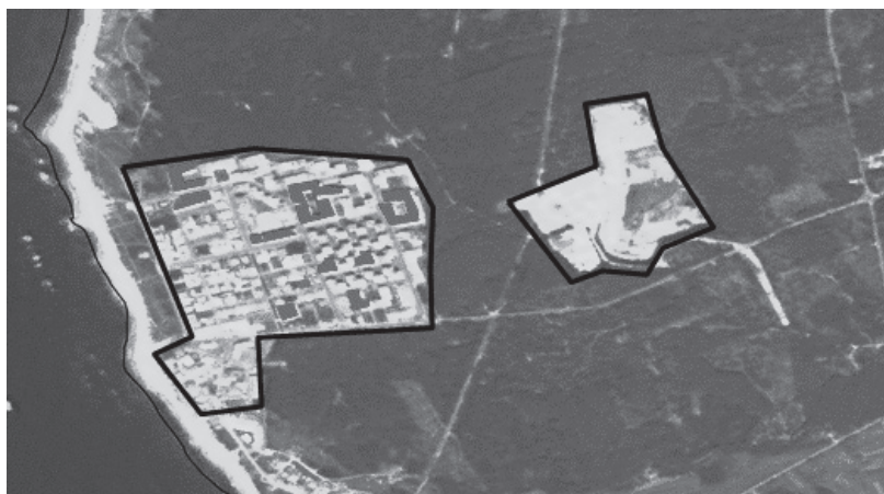
Figura 2 Exemplo de identificação de zonas urbanizadas e de edifícios numa imagem SPOT5 (5 m)
