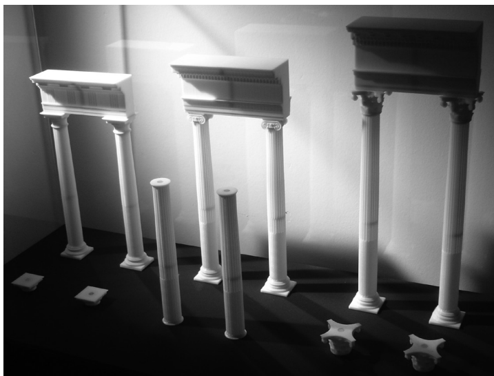
Fig. 3 - Modelos físicos de elementos do sistema da coluna gerados de acordo com a respectiva gramática e produzidos por prototipagem rápida.
