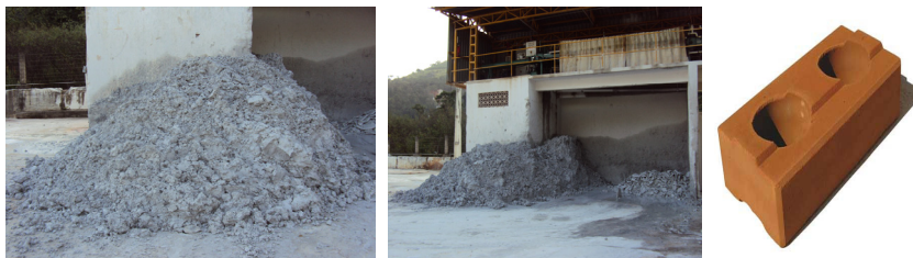
Figura 3. Um dos maiores problemas da atividade mineira, no tocante aos aspectos ambientais: a questão da lama abrasiva, que pode ser reutilizável na construção civil.
