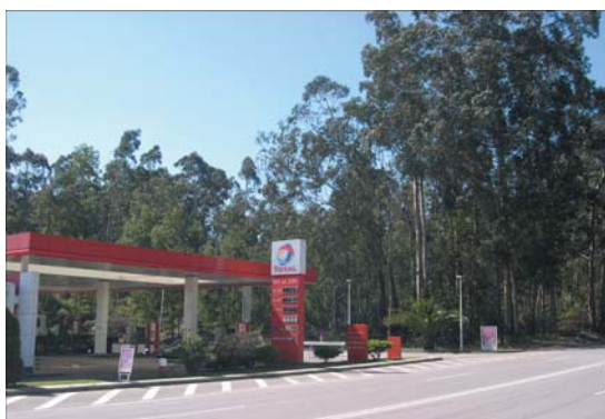
Rot. 4 - Bomba de gasolina com materiais altamente inflamáveis no interior de uma área florestal, sem qualquer faixa de proteção
