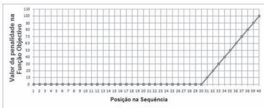
Figura 3: Representação da função objetivo para 30 carros especiais e 40 posições, considerando que os carros especiais devem ficar em primeiro lugar na sequência.
