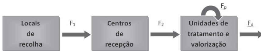
Figura 5: Representação esquemática da rede logística de recuperação de REEE
