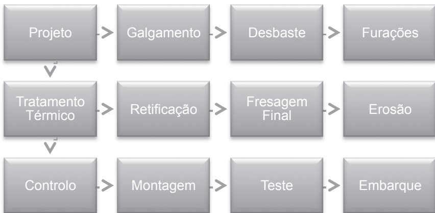
Figura 3: Processo de fabrico de um molde.
