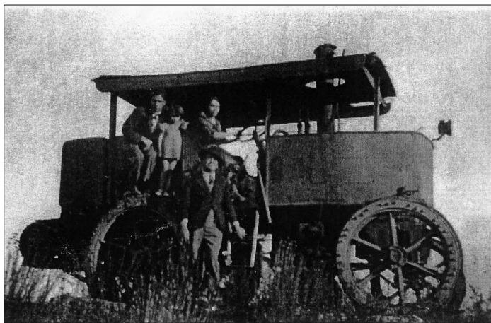
Figura 1 – Locomóvel ao serviço da empresa mineira para transportes gerais e apoio à construção da linha férrea. Anónimo, final dos anos vinte.
