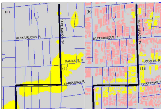
Fig. 6 - Ponto de inundação (1) detectado através da simulação gerada no sistema de modelagem de risco, onde (a) representa a provável área de abrangência do evento e (b) as prováveis edificações afetadas. Fonte: SANTOS, 2010.
