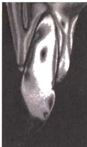
Fig. 3.32 - Indicação dos esforços num modelo através das franjas isoclínicas e isocromáticas.
