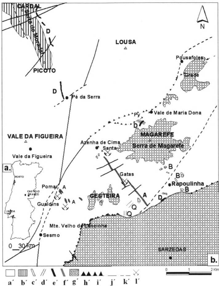
Fig. 1 - a. Localização da área em estudo; b. Mapa geológico da região de Sarzedas (Adaptado de SHEPHERD, 1994). a' - Complexo Xisto-Metagrauváquico (Câmbrico); b' - Quartzitos Armorianos; c' - diques ácidos Pré-Variscos; B; d' - Filões de quartzo mineralizados provavelmente Variscos; Q; e' - Diques de diabase Variscos; D; f' - Diques felsíticos Variscos (A); g' - Depósitos de Cobertura Terciária e Quaternária; h' - Cavalgamento; i' - Cavalgamento provável; j' - Falha; k' - Falha provável; l' - Explorações mineiras abandonadas.
