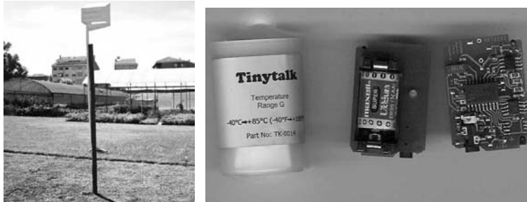
Figura 1- Posto fixo de medição (Covelo); sonda térmica Tinytalk utilizada nos postos fixos
