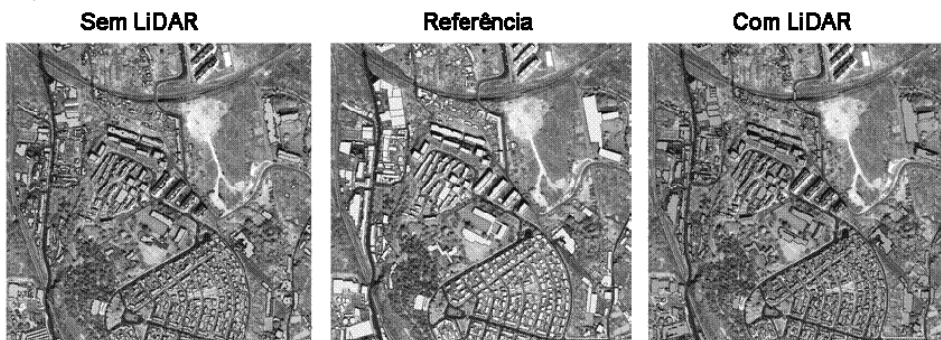
Figura 2 – Resultado da extracção da classe “Edifícios” utilizando os dois conjuntos de dados.
