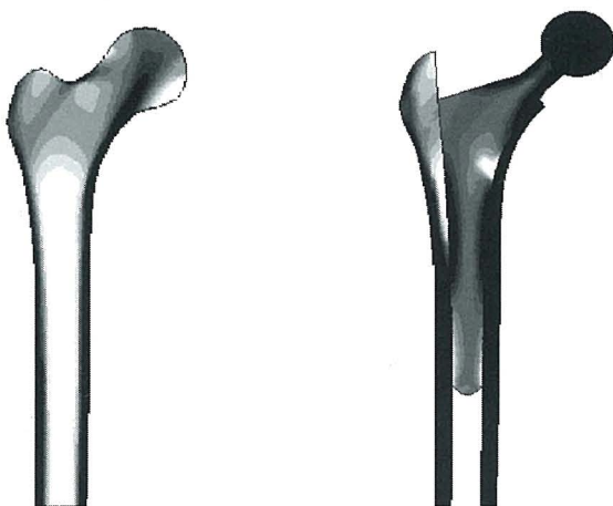
Fig. 7 — Distribuição numérica da densidade com e sem prótese
