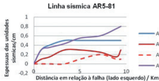
Fig. 6 – Variações de espessura/distância da linha sísmica AR5-81. O anticlinal associado à falha marcada funciona como estrutura de referência (1ms=1cm).
